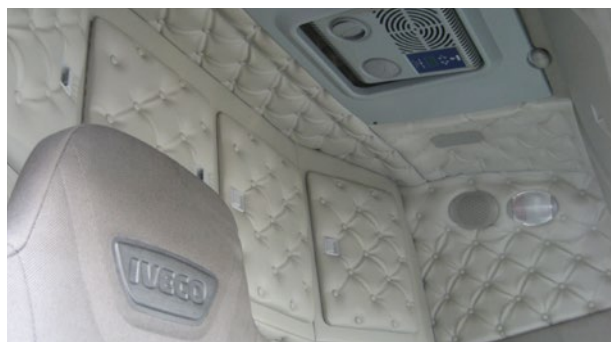
Descoloração ligeira devido aos raios de sol
