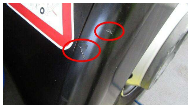
Riscos impercetíveis com a unha e superfície \leq 45 \text{ cm}^2 (equivalente a um cartão de crédito)
