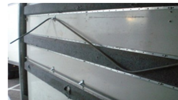
↻ Estofos e hastes: hastes, fixações, estofos em falta ou deformados excedem a reparação económica
