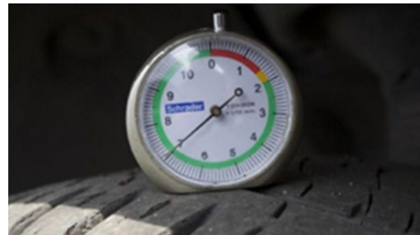
Pneus: piso com, profundidade \geq 7 mm (CONFORME)
