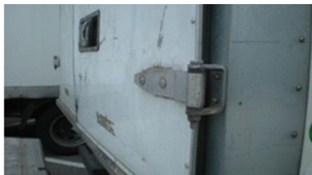
↻ Portas laterais e traseiras: portas dobradas nos pontos de fixação das dobradiças, partidas, perfuradas ou que excedam a reparação económica
