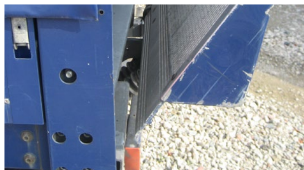
✂ Taipal de carregamento: deformações da plataforma dentro da reparação económica
