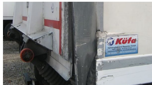
🔧 Portas laterais e traseiras: deformação significativa
