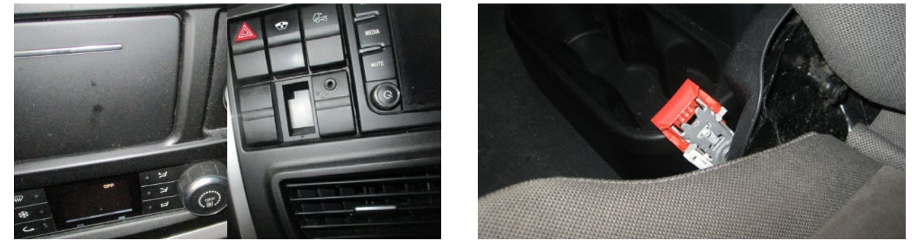
Peças de comando, peças do banco ou do revestimento em falta, partidas ou perfuradas
