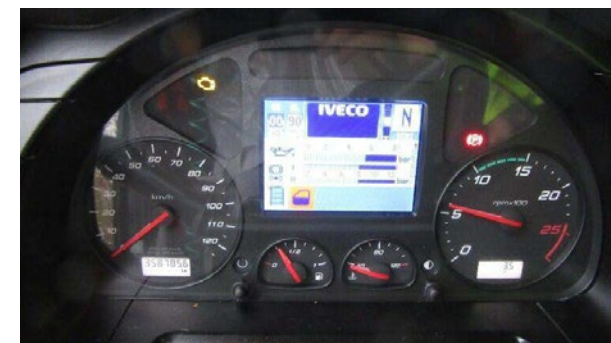
Riscos no painel de instrumentos combinado e outros danos visuais ou orifícios no campo de visão
