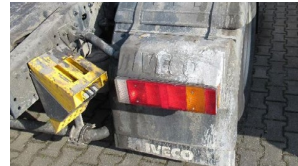
Descoloração profunda devido aos elementos químicos
