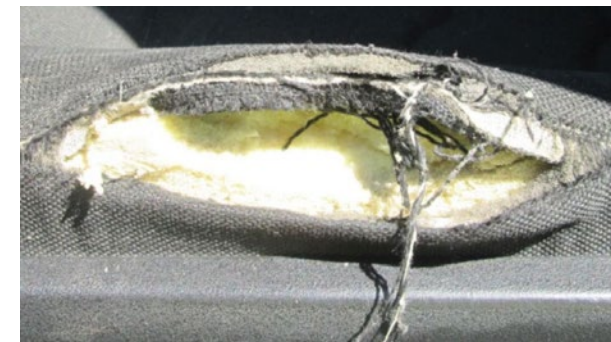
Falta da espuma ou estrutura partida
